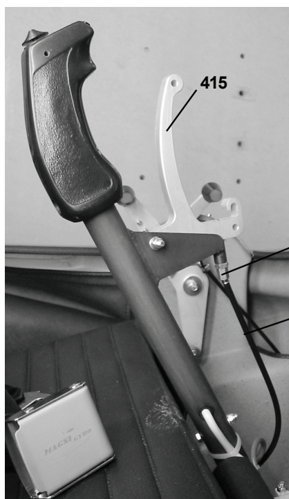
Fig. 3.2/1 Registro cavo comando prerotazione Prerotation control cable adjuster
